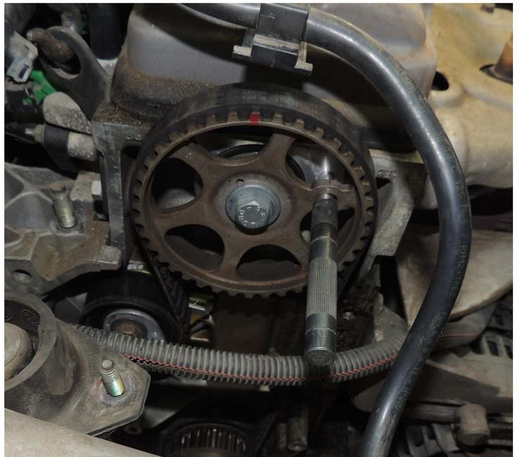
Mettre en place la courroie de distribution
