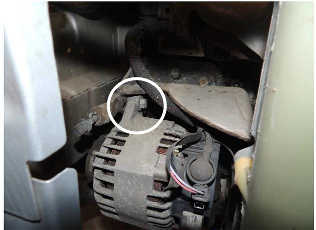
Repérez la position du tendeur ( X mm ) et détendre ( clé de 10 ) et enlever la courroie d' alternateur
