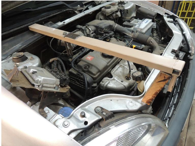
Démontez le support moteur ( 2 écrous clé de 13, 3 écrous clé de 16 )
