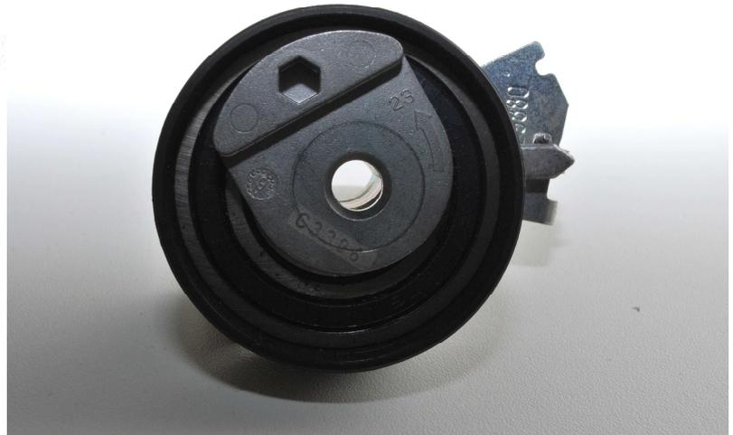
13- Maintenir le galet dans la position de réglage et serrez l'écrou de fixation du tendeur au couple de :
