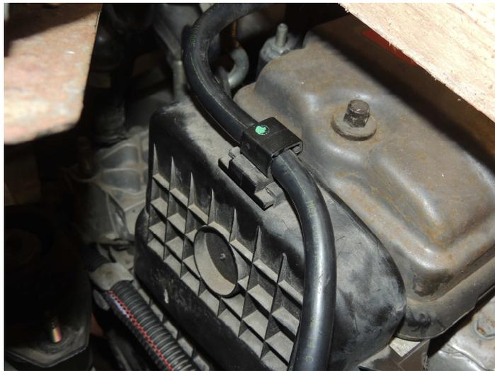
Remontez le support moteur ( 2 écrous clé de 13, 3 écrous clé de 16 ) Couple de serrage **4.3 - 4.7 daNm**
