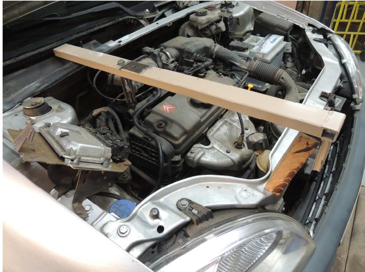
Remonter le calculateur ( 2 vis ,un écrou clé six pans de 8 )
