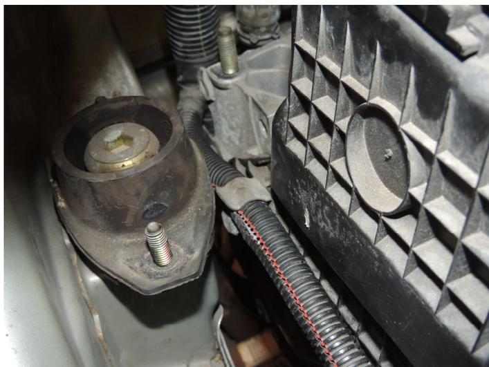
Remontez le cache de courroie de distribution supérieur ( 2 vis clé de 10 )
